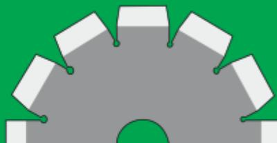
Para cortar e furar, são necessárias medidas de controle: Corte com água ou utiliza extrator de poeira.
